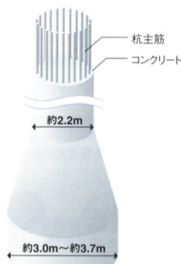
場所打ちコンクリート杭イメージ
