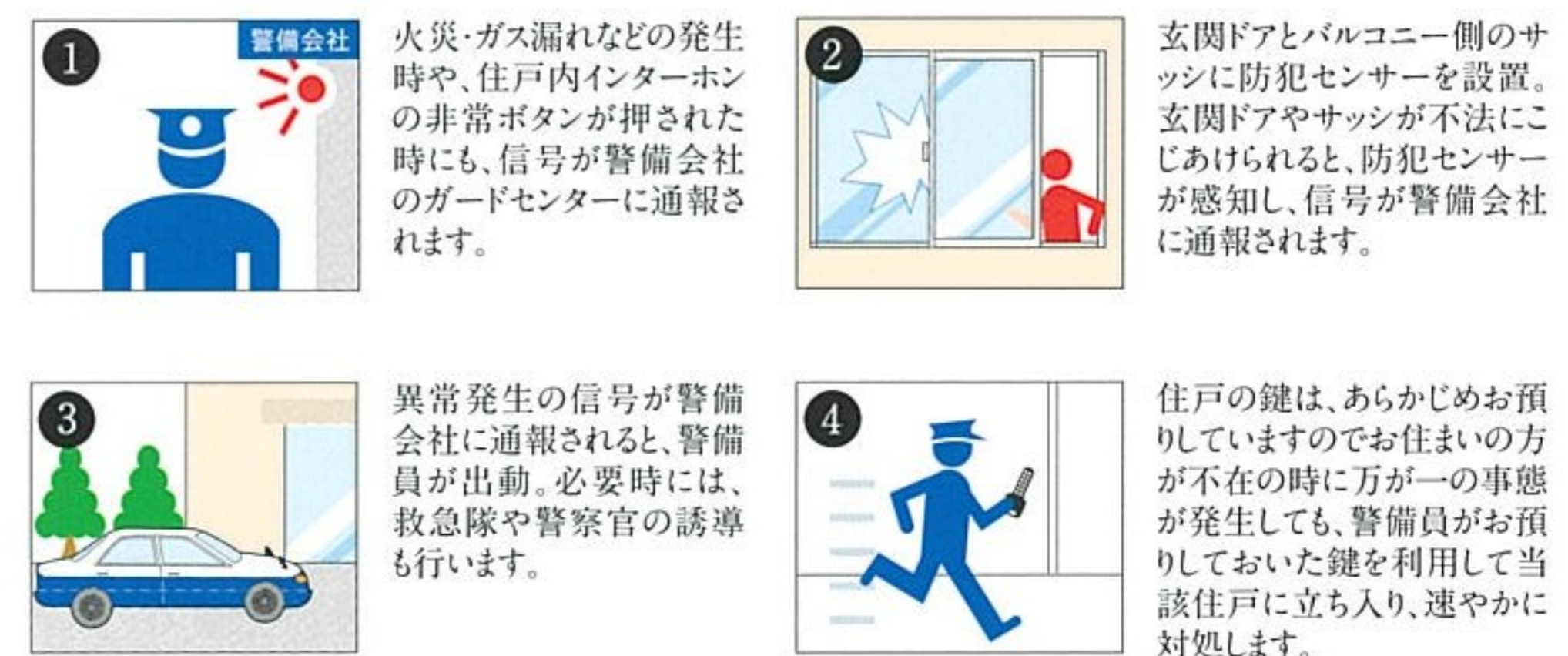
【各種センサーが感知した場合のシーエルガードの流れ】
